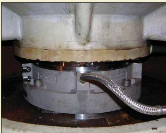
Delade tätningar installeras och repareras utan demontering av utrustningen. Det sparar tid och ger lägre driftkostnader.
